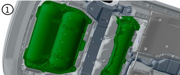
Absperrventile der Gastanks lokalisieren
