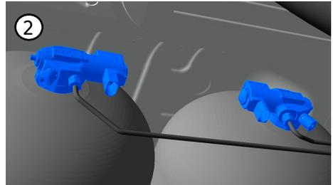
Absperrventil mit 5-er Maul- bzw. Ringschlüssel in Uhrzeigersinn bis zum Anschlag drehen
