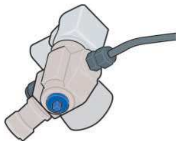
manueller Absperrhahn am Fuß des Flaschenventils.
