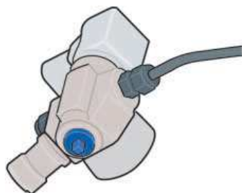
manueller Absperrhahn am Fuß des Flaschenventils.
