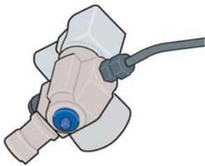
manueller Absperrhahn am Fuß des Flaschenventils.
