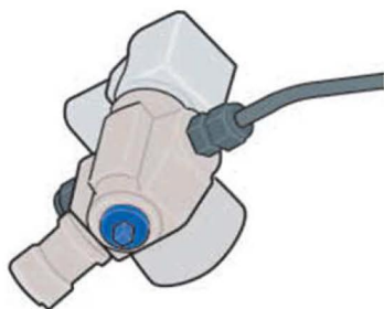
manueller Absperrhahn am Fuß des Flaschenventils.
