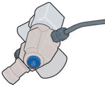
manueller Absperrhahn am Fuß des Flaschenventils.
